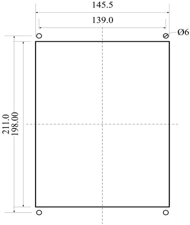
注：在屏柜上开矩形孔，固定方式为螺钉固定，推荐采用 $\varnothing 5$ 螺栓固定；
